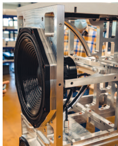
STARKES GERÜST: So werden die 30-cm-Woofer der Reference gehalten.
