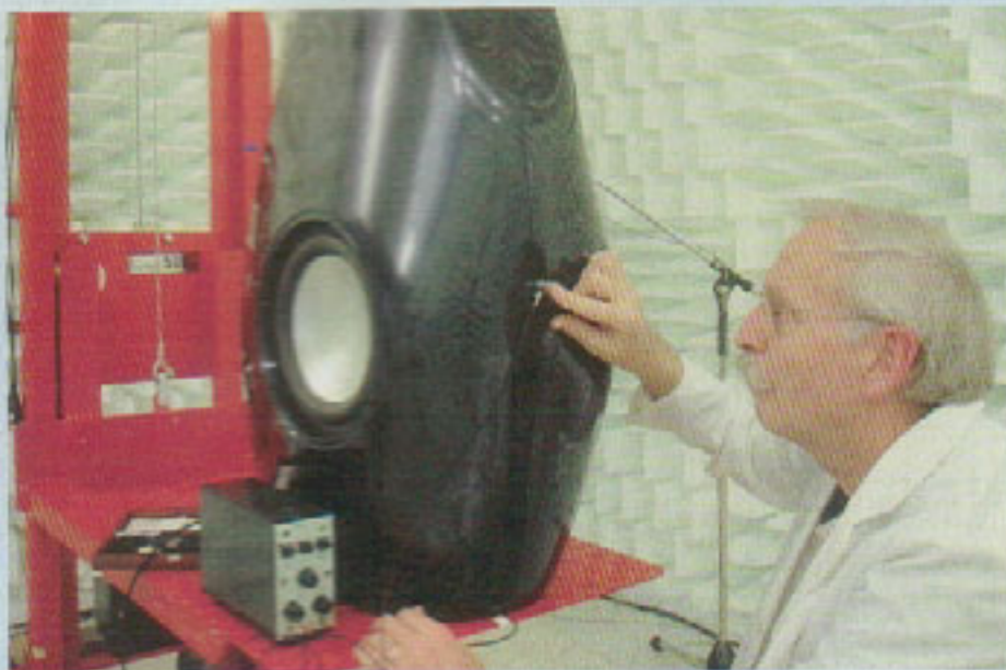
Laborleiter Peter Schüller beim Aufspüren von Gehäuseresonanzen mittels Beschleunigungsaufnehmer von Bruel & Kjaer.
