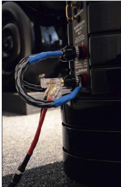
**GEBRÜCKT:** Kabelbrücken von Kimber sorgten beim Single-Wiring für die Verbindung zum Mittelhochtonbereich.
