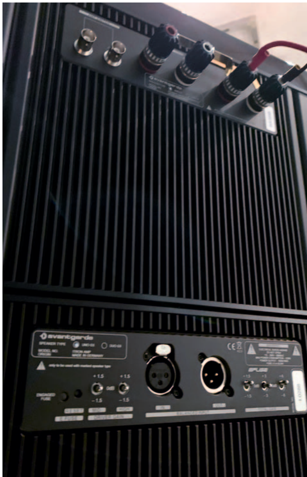
BETRIEBSBEREIT: Rücken der Uno SD beim Vorführmodell von Aug & Ohr. Hier in der Variante für den Anschluss einer externen Endstufe für Mittel/Hochton. Darunter das iTRON-Verstärkermodul mit fünf Kippschaltern zur Feinabstimmung und symmetrischen XLR-Anschlüssen.
