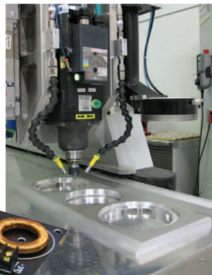
▲ GEFRÄST AUS FLUGZEUG-ALUMINIUM: Die Schallwand eines YG-Lautsprechers wird mit haus-eigenen Maschinen hochpräzise aus ganzen Blöcken des Metalls herausgearbeitet.
